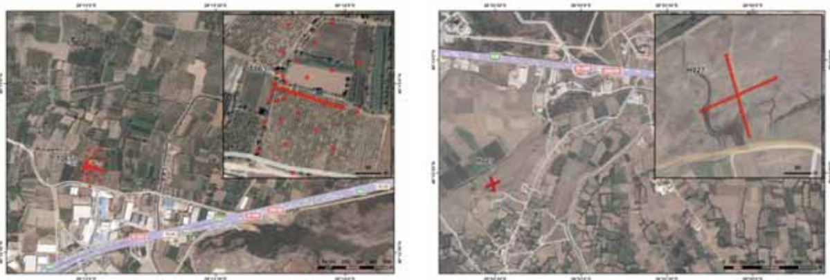
Şekil 1. Proje kapsamında gerçekleştirilen Vs30 hızı ve Zemin Sınıflaması ölçümlerinde kullanılan dairesel dizilim (sol) ve artı dizilim (sağ).
