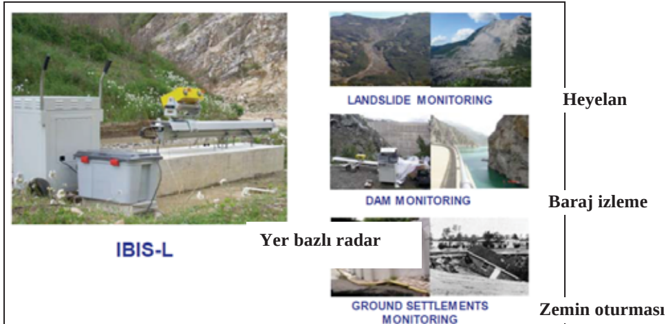
Şekil 6. Yer bazlı radar ve uygulama alanları [12]
