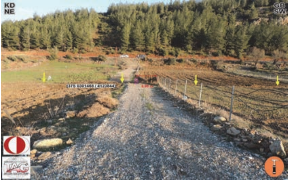
Şekil 12b: Vadi içinde yolda sol yanal atım (2.95 m). Sarı oklar yüzey yırtılmasını işaret etmektedir.
