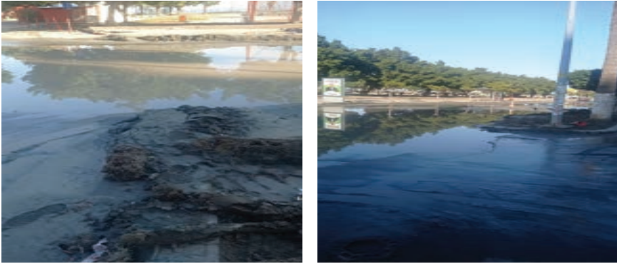
Şekil 33. Hatay-İskenderun ilçesinde sıvılaşma sonrası yeraltı suyu çıkışı
