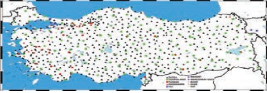
Şekil 3. Türkiye Referans Çerçevesi (TUREF) hız alanını belirlemek amacıyla kullanılan GNSS kontrol noktaları (HGM, 2023)
