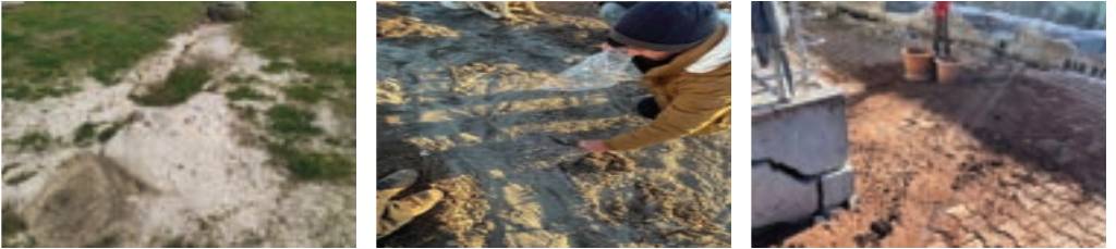
Şekil 44. Sırasıyla Hatay, Kahramanmaraş ve Adıyaman illerinde meydana gelen sıvılaşma olayı (ODTÜ, 2023)
