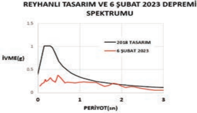
Şekil 4. Reyhanlı ivme kaydından hesaplanmış tepki spektrumu ve aynı nokta için Tasarım Spektrumu. (N. Bayülke)
