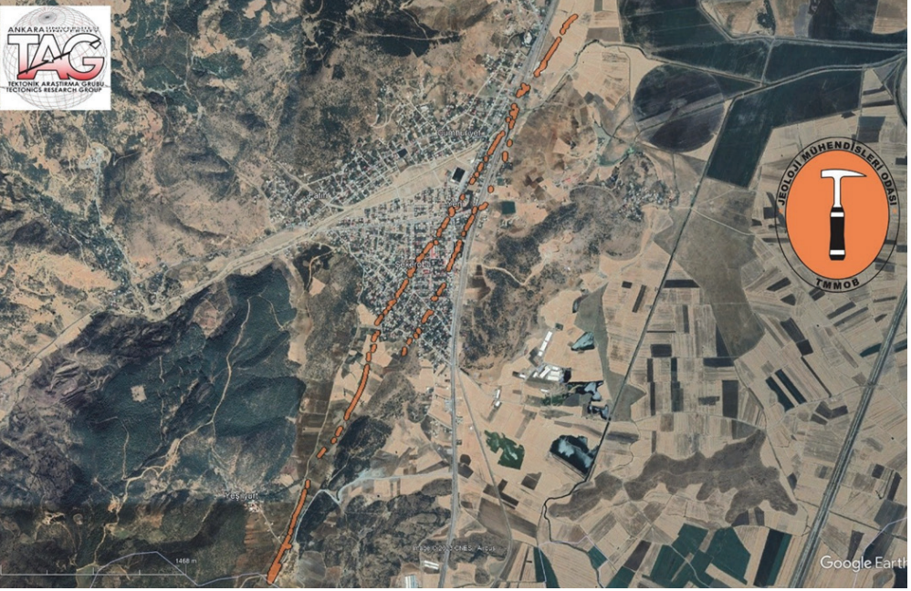
Şekil 10: Harita Genel Müdürlüğü "Küre" uygulaması kullanılarak elde edilen Şekeroba yerleşiminde yüzey yırtılması haritası ( https://www.researchgate.net/publication/368817386 ).
