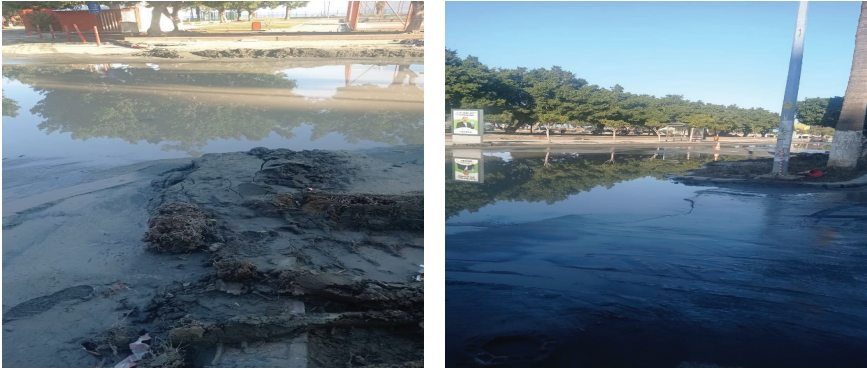
Şekil 33. Hatay-İskenderun ilçesinde sıvılaşma sonrası yeraltı suyu çıkışı
