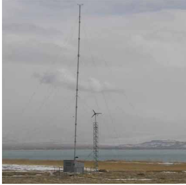
Şekil 2. Y.Y.Ü. Kampüsünde kurulan 30 m yüksekliğindeki rüzgar enerjisi ölçüm direği ve 1 kW gücündeki rüzgar türbini.
